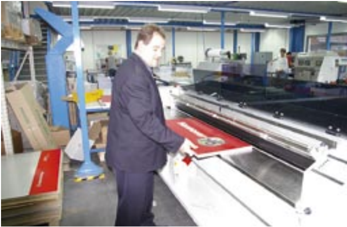
Zur Oberflächenveredelung kommt der Seal 72 UV Coater zum Einsatz. Probleme mit Laminierfolien sind damit erledigt.
