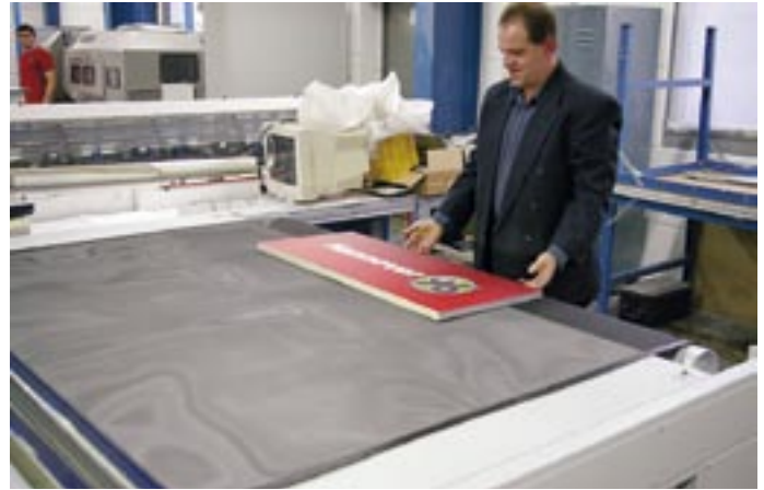
Drucke auf Rigidmaterial werden mit einer CNC-Fräse vollautomatisch ausgesägt – so sieht schlanke Produktion aus.
