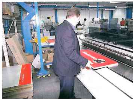
Frank Langer, Geschäftsführer von Digital Print lackiert ein Teil einer Schrankwand mit dem 72 UV Coater.
